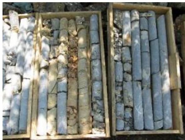
Слика број 4 - Глиновита испуна каверне, В6/19
